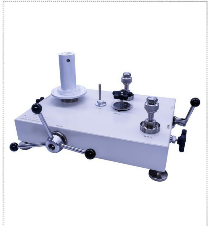
XY551-1 型液压式压力天平
